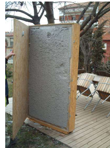
Injection of EPS with graphit from the outside Agència de l'Habitatge de Catalunya
